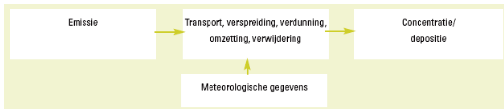
Afbeelding 33 Schematische opzet van een atmosferisch-chemisch transportmodel. Bron: Er zij een meetnet.
