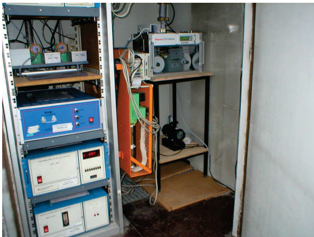
Afbeelding 22 Interieur van een hedendaags meetstation voor luchtkwaliteit in het Landelijk Meetnet Luchtkwaliteit. Aan de linkerkant een aantal meetsystemen voor gasvormige luchtverontreiniging. Rechts bovenin een moderne \beta -stofmonitor. Het oranje onderdeel bevat de datacommunicatieapparatuur waarmee alle meetapparatuur informatie kan uitwisselen met een centraal computersysteem van het Laboratorium voor Milieumetingen van het RIVM in Bilthoven. Vanuit Bilthoven gaan de data onder andere naar Teletekst (zie Afbeelding 23). Foto: Laboratorium voor Milieumetingen, RIVM; met dank aan Dick van Straalen.
