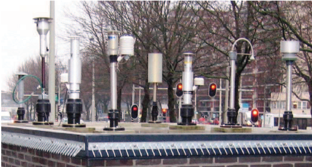
Afbeelding 30 Vergelijkend onderzoek met verschillende meetsystemen en van verschillende instanties kan een belangrijke bron van informatie zijn. Zulk onderzoek wordt onder andere uitgevoerd door DCMR Milieudienst Rijnmond en het Laboratorium voor Milieumetingen van het RIVM op een meetstation in Rotterdam. Het meetstation bevindt zich op de hoek van het Bentinckplein en de Statenweg in het noordelijk deel van Rotterdam.
